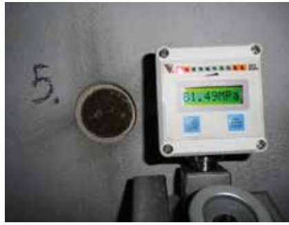
Fot. 4. Szczegółowe kontrole obejmowały wiele etapów prac (m.in. pomiary grubości świeżo nałożonych powłok oraz ich adhezji do podłoża)
