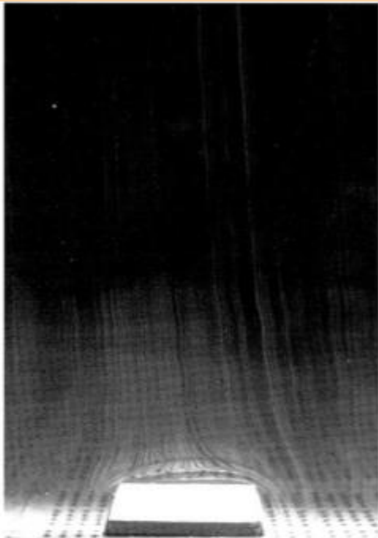
Bild 11.1: Strömung 0,45 m/s über einer Heizplatte mit 1 kW Leistung
